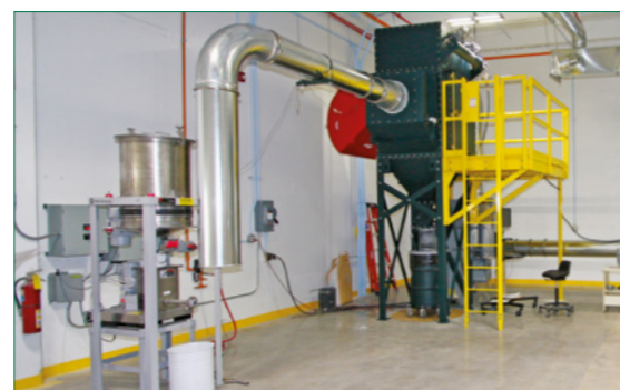
Aparatura pomiarowa do przeprowadzania testów zgodnie z ASHRAE 199
