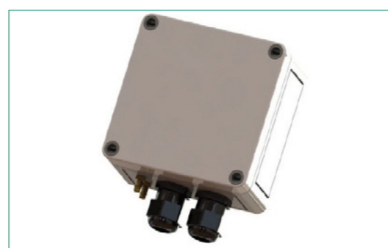
Aparatura pomiarowa do przeprowadzania testów zgodnie z ASHRAE 199
